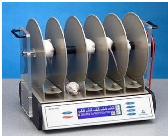
Hình 2.8. Mô hình trục quay Rotarod
